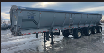
Remorque Trout River 2021 , modèle HC-48 live bottom, high cube 130", 4 essieux, ess. relevable sur premier du tridem, toile El Cargo, inspection SAAQ lors de la vente P.S.D. Tél.: 450-753-0234
