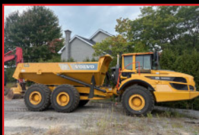
VOLVO A25G 2023 , 1,480 heures, pneus Michelin 23.5r25, caméra de recul, balance intégré
