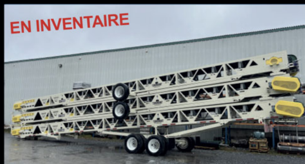
Convoyeurs (3) Stacker pack MGR 36" X 60' - Capacité 600 TPH
