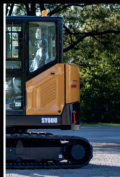
RAYON D'OSCILLATION RÉDUIT 4' 5"
