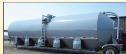
Citerne Silo d'entreposage pneumatique , 4,000 pi.cu. en acier, un compartiment, 2 lignes de remplissages, décharge sur ligne de 5", le souffleur est pas inclus, disponible pour la location P12511
