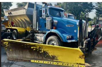
KENWORTH T800 2010 , Cummins ISX 485 hp, 18 vit., 18/46 "Full Lock", équip. à neige Tenco, peigne ventral, Dickey John, saleuse Stainless 12 verges
