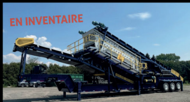
Plan tamisage portatif Haver 7' x 20' x 3 decks – Capacité 800 TPH
