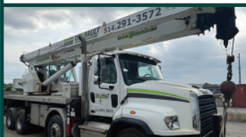
Grue Altec 38127S 2016 , 127' de flèche, 2 jibs, cabine tilt, contrepoids ajouté, un seul propriétaire, montée sur camion Freightliner 114SD avec mot. Detroit, insp. SAAQ P.S.D. Tél.: 514-291-3572
