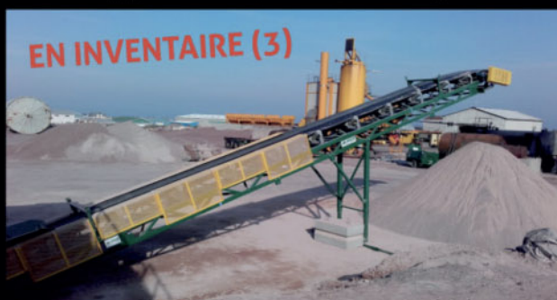
Convoyeur empilable MGR 36" x 50' – Capacité 500 TPH
