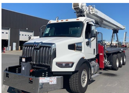
2025 LOAD-KING LK-35100, sur Western Star 47X, capacité de 35 tonnes, flèche 30.5'/100', fléchette 30.5'/55'
