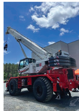
2025 LINK-BELT 100RT, flèche 40.6'/155', fléchette 35'/58', bloc 4 poulies 60 tonnes, boule crochet 10 tonnes
