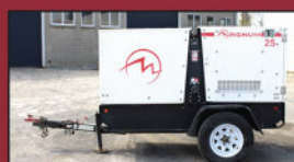
(2018) Génératrice Generac Magnum 25, 25 KW, diesel, moteur Isuzu
