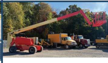
Nacelle articulée JLG 4X4 2013, levage 80', travail 86', capacité 500 lb, portée horizontale de 52', 4 pneus remplis en mousse P.S.D.
