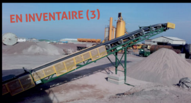
Convoyeur empilable MGR 36" x 50' – Capacité 500 TPH
