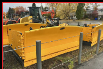
Gratte à neige S.HOULE L+1022 neuve , A/R iso, lame de 10' avec oreilles de 6' chaque
