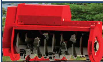
Broyeur forestiers de marque Fecon, pour excavatrices de 3 à 12 tonnes
