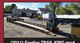
(2011) Fardier TRAIL KING mod. TK 110DG, 55 tonnes détachable hydraulique, 26' plancher dropside 3 essieux, pneus 305
