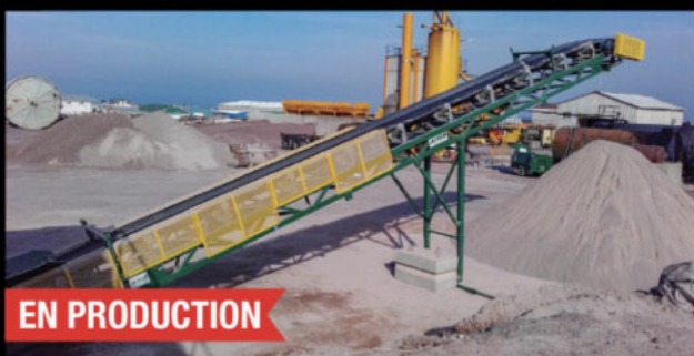
Convoyeur empilable MGR 36" x 50' - Capacité 500 TPH
