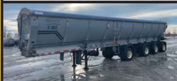
Remorque Trout River 2021 , modèle HC-48 live bottom, high cube 130", 4 essieux, ess. relevable sur premier du tridem, toile El Cargo, inspection SAAQ lors de la vente P.S.D. Tél.: 450-753-0234
