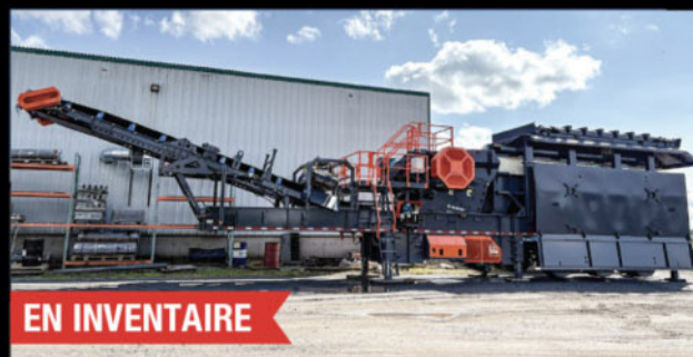
Station primaire Sandvik CJ-412 - Capacité 600 TPH
