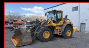
VOLVO L90H 2019 , 3,500 h., 3ième valve, A/R hyd., "Ride Control", graisseur automatique
