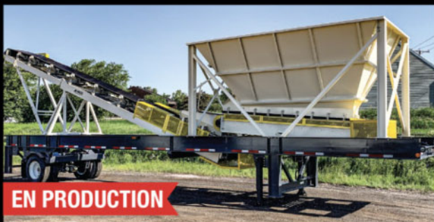
Trémie portative MGR 20 tonnes - Capacité 300 TPH
