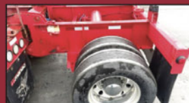
Fardier / essieu amovible /flip axle:(2016) MANAC, suspension à air, Budd wheels
