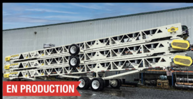
Convoyeurs (3) Stacker pack MGR 36" X 60' - Capacité 600 TPH
