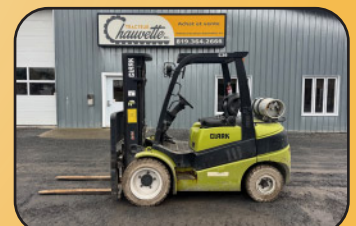
Chariot élévateur CLARK C30L 2012 , 1,105 heures, moteur propane, transm. automatique, mât à 3 sections et "Side Shift", "Free Lift", cap. de 6,000 lb, pneus non marquants $ 17 500
