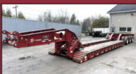
(2019) Fardier MANAC 55 tonnes, 26' plancher, détachable hyd. 3 essieux
