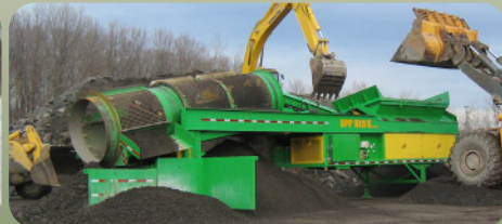
IPF 513E Série III, nouveau modèle abaissé avec panneaux d'acier intégrés sans convoyeur
