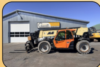
Chariot télescopique JLG 1055 2017 , 4x4, transm. automatique, cabine, élévation de 55', cap. de 10,000 lb, pattes stabilisatrices $ 79 500
