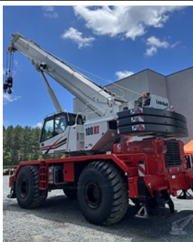
2025 LINK-BELT 100RT NEUF , flèche 40.6'/155', 5 sections télescopique, fléchette 35'/58'
