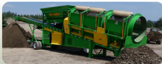
IPF 518C Tamiseur à haut rendement Pour terre et sable MUNI DE 4 VIBRATEURS
