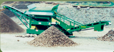
IPF 200X, produit 4 matériaux en 1 seule opération, Installation rapide, idéal pour chargeurs de 4 à 5 v 3
