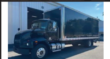
MACK MD742 2021 , moteur Cummins 250 hp, Allison 6 vitesses, fourgon 26' avec monte-charge 4,000 lb P.S.D. Frédéric: 418-563-0340
