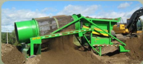
IPF 513 Facilité & Rapidité d'installation pouvant tamiser terre, sable et gravier
