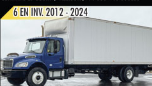
6 EN INV. 2012 - 2024 FREIGHTLINER M2 106 2012 #C-33879 CUMMINS ISB 220HP / ALLISON / 12 000 - 23 000LBS
