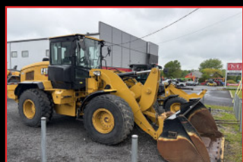
CATERPILLAR 938M 2021 , 3,100 heures, A/R hyd., "Ride Control", 3 e valve, graisseur auto.
