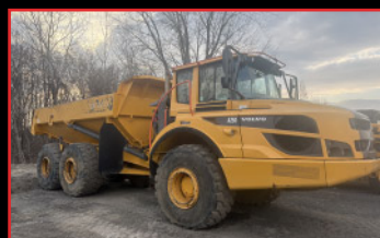
VOLVO A25G 2020 6x6 , 4,400 heures, 25 tonnes de capacité, porte arrière
