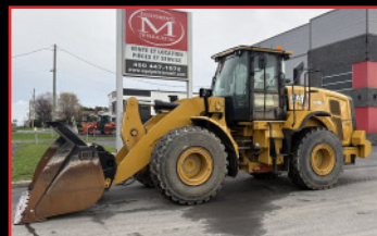
CATERPILLAR 950M 2023 , 500 heures, balance intégrée, "Ride Control" 3 e valve, Attache rapide fusion
