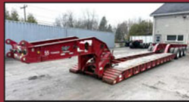
(2019) Fardier MANAC 55 tonnes, 26' plancher, détachable hyd. 3 essieux
