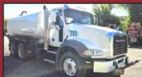
(2020) Camion arrosoir MACK Granite CX613, transmission automatique, réservoir 4,000 gal., jets à pression avant/côtés & arrières
