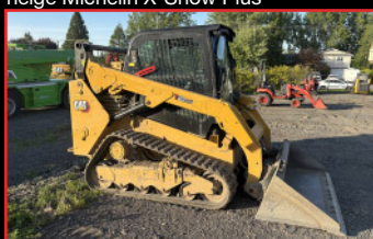
CATERPILLAR 259 D3 , 2,000 heures, attache rapide hydraulique, cabine fermée, A/C
