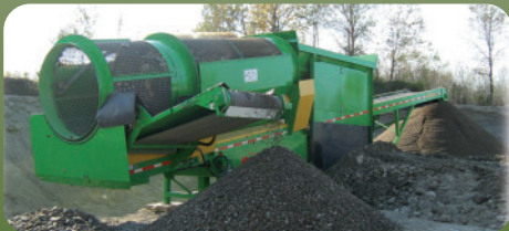
IPF 513EC Serie II, peut tamiser terre, sable, gravier et fabriquer de la pierre nette, 2 convoyeurs de sortie intégrés
