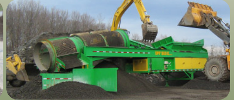
IPF 513E Série III, nouveau modèle abaissé avec panneaux d'acier intégrés sans convoyeur
