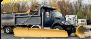
INTERNATIONAL 7400 2018 12 ROUES #C-36722 CUMMINS ISL 330HP / ALLISON / 18 000 - 40 000
