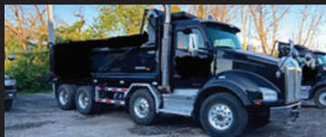
KENWORTH T880 2018, mot. mx13 455 hp, 2 ième essieu fixe tardif, transm. Fuller 18 vit., full air, "Full Lock", 18/18/46 panneaux à neige, possibilité d'échange pour une pelle de 12 à 25 tonnes, +/- 3,000 heures Financement disponible $ 145 000 Tél.: 514-269-7229
