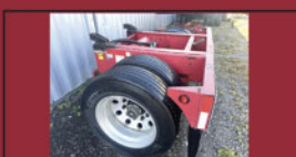
Fardier/essieu amovible: (2016) XL Specialized essieu amovible/flip axle, suspension à air
