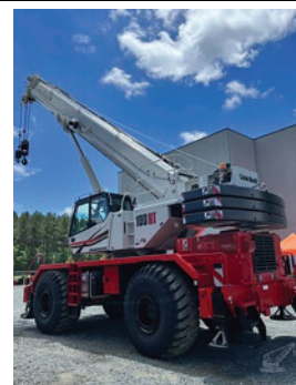
2025 LINK-BELT 100RT, flèche 40.6'/155', fléchette 35'/58', bloc 4 poulies 60 tonnes, boule crochet 10 tonnes
