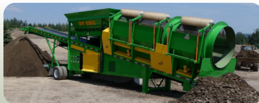
IPF 518C Tamiseur à haut rendement Pour terre et sable MUNI DE 4 VIBRATEURS
