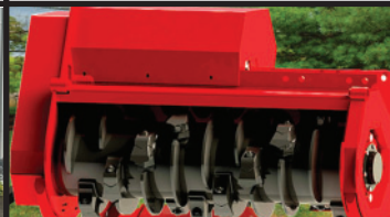
Broyeur forestiers de marque Fecon , pour excavatrices de 3 à 12 tonnes P.S.D. Tél.: 418-831-3334
