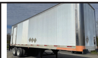
Remorque fermée 32', avec hayon (Tail-gate), unité hydraulique neuve avec capacité de 2,500 livres, inspection SAAQ valide
