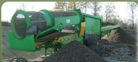
IPF 513EC Série II, peut tamiser terre, sable, gravier et fabriquer de la pierre nette, 2 convoyeurs de sortie intégrés
