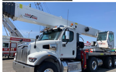
2025 LINK- BELT 100RT NEUF, flèche 40.6'/155', 5 sections télescopique, fléchette 35'/58'
