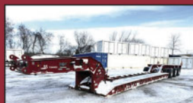
(2019) Fardier MANAC 55 tonnes, 26' plancher, détachable hyd. 3 essieux
