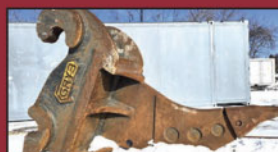
Défonceuse /Ripper GRYB quick attach pour excavatrice 40 à 49 tonnes
