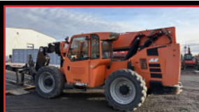
SKYTRAK 10054 2017 , 3,000 heures, 10,000 lb. cap., 54' d'élévation
