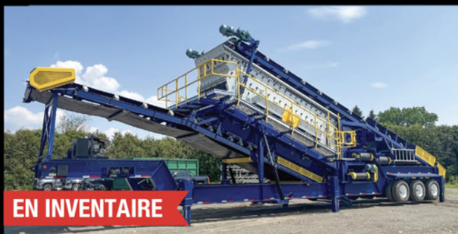
Plan tamisage portatif Haver 7' x 20' x 3 decks - Capacité 800 TPH
