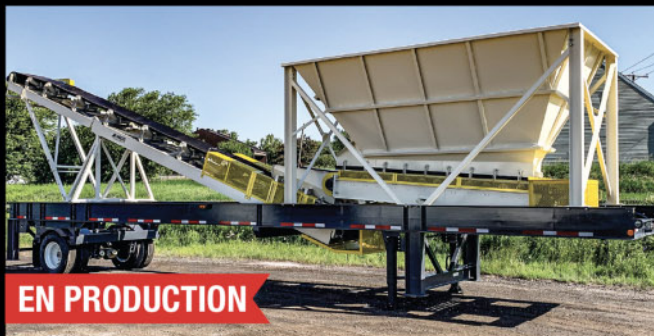
Trémie portative MGR 20 tonnes - Capacité 300 TPH
