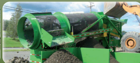
IPF 513E, avec panneaux d'acier in- tégrés, pour tamiser terre, sable, gravier et fabriquer de la pierre nette
